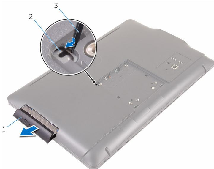
1 Ensamblaje de la unidad óptica
